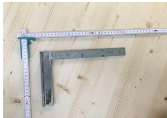
Fixierung eines rechten Winkels
