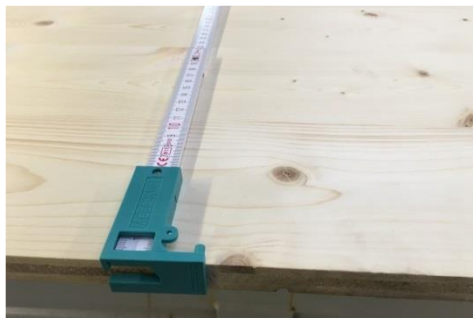
Fester Anschlag wie bei einem Maßband
