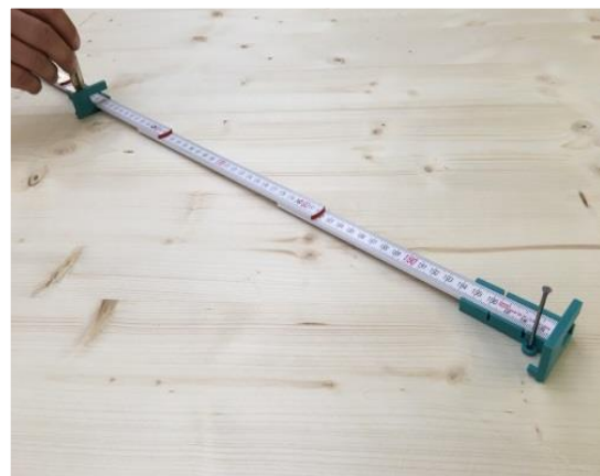
Zirkelfunktion durch beidseitige Fixierung
