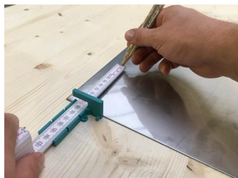
Anzeichnen und Anreißen an scharfen Kanten
